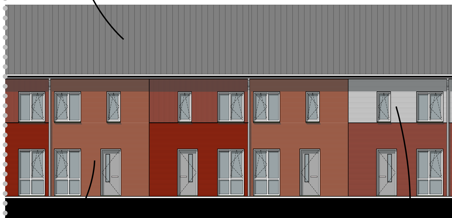
WITTE HOUTEN DELEN / GEKEIMD METSELWERK
